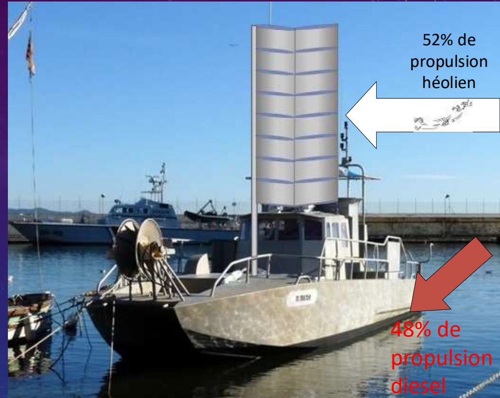
Bateau de pêche avec la voile automatique schématisé Source image : Sylvain Pagnon
